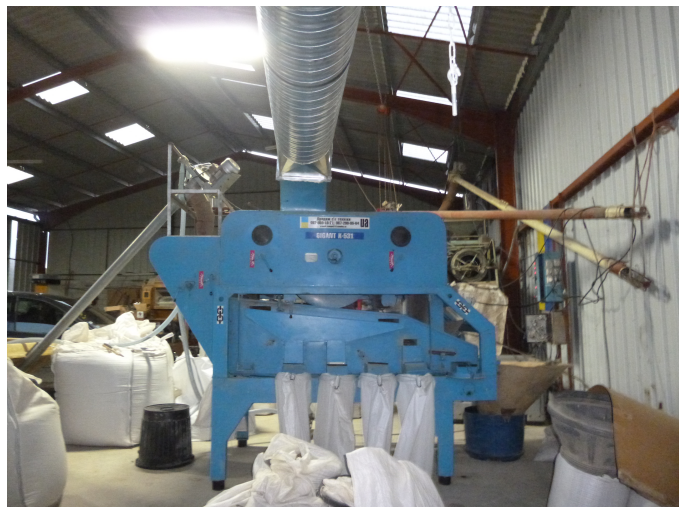
Photo 3 : nettoyeur-séparateur à 2 grilles planes de calibres différents (10/2016) © L. Zaccagnini
