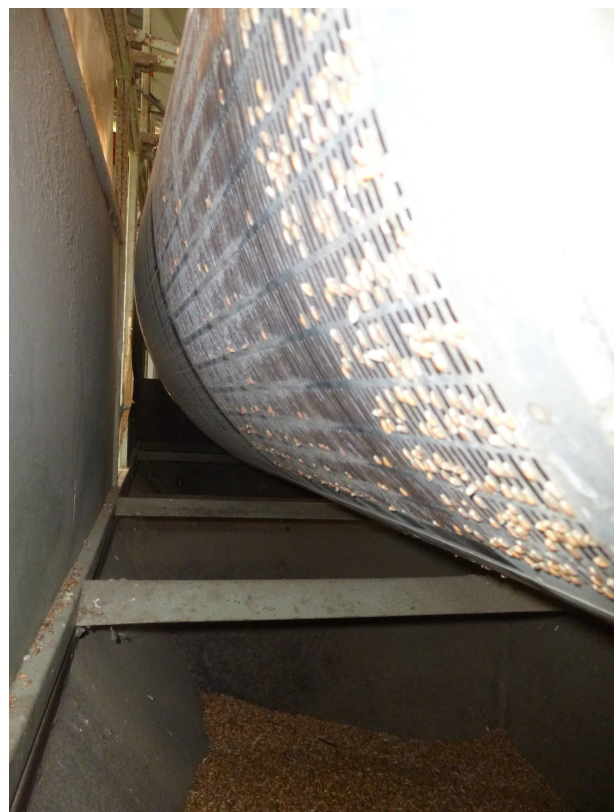
Photo 2: Trieur alvéolaire vue intérieure (10/2016) © L. Zaccagnini
