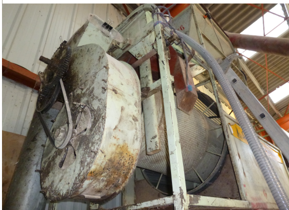
Photo 1: Trieur alvéolaire vue extérieure (10/2016) © L. Zaccagnini
