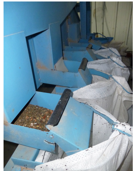
Photo : Déchets issus du tri d'un nettoyeur-séparateur à grilles superposées (10/2016) © L. Zaccagnini
