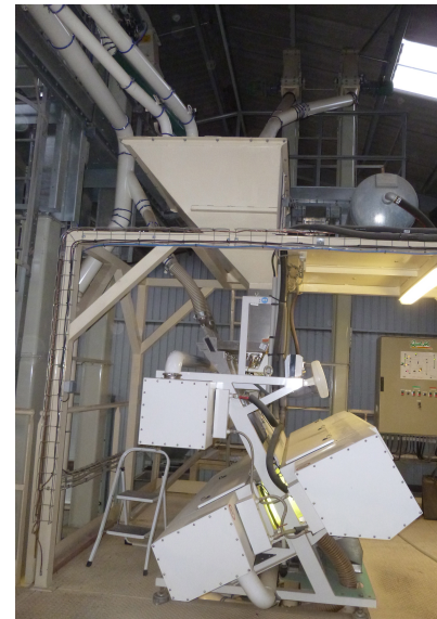
Photo 2 : trieur optique de la coopérative Qualisol (10/2016) © L. Zaccagnini
