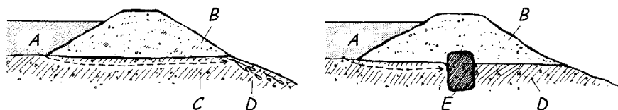
Figure 31 : La fonction du noyau (Murnyak et Murnyak, 1990). A : l'eau; B : le mur de terre de l'étang; C : terre; D : l'eau infiltration; E : le noyau argile.
