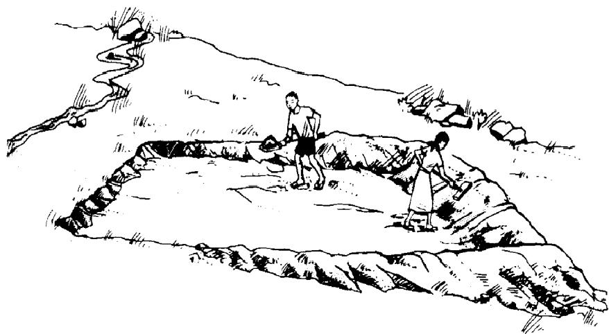
Figure 27 : Étang selon les courbes de niveau (Murnyak et Murnyak, 1990).
