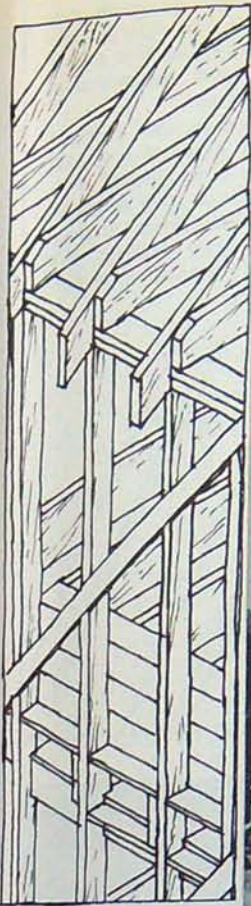
CONSTRUCTION D'UNE GRANGE A PARTIR D'UNE STRUCTURE A TENONS ET MORTAISES A LA FERME DE JACOB ROBERT MASSILLON, OHIO 1888
