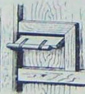
VERROU DE LA PETITE PORTE A GLISSIERE DANS LE PORTAIL
