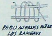
ENROULEMENT DES FIBRES TENDUES AUTOUR D'UN SEUL RAMEAU ET REPLIS ALTERNES.
