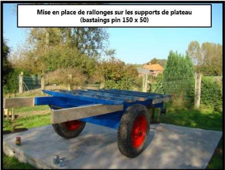
Mise en place de rallonges sur les supports de plateau (bastaings pin 150 x 50)
