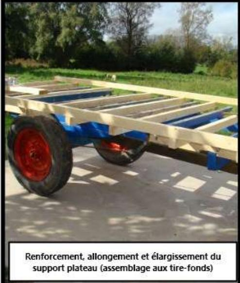
Renforcement, allongement et élargissement du support plateau (assemblage aux tire-fonds)
