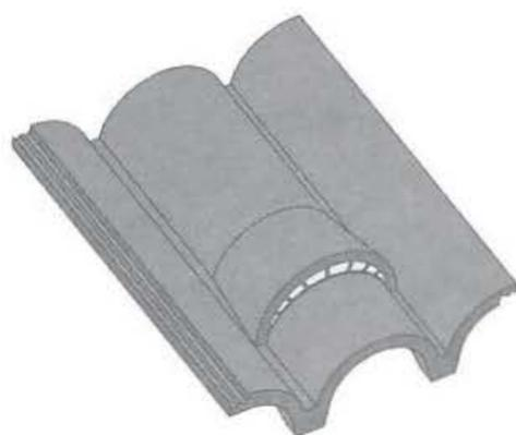
tuile à glissement en béton
