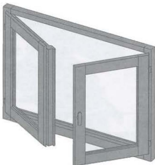
fig. 11.1 fenêtre isolante en bois à deux vantaux
