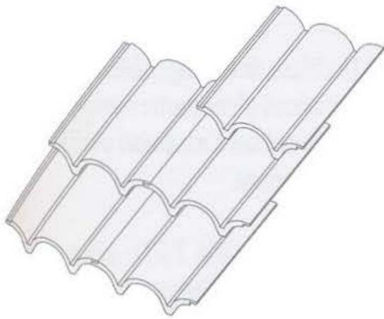
fig. 7.18 assemblage de tuiles à glissement
